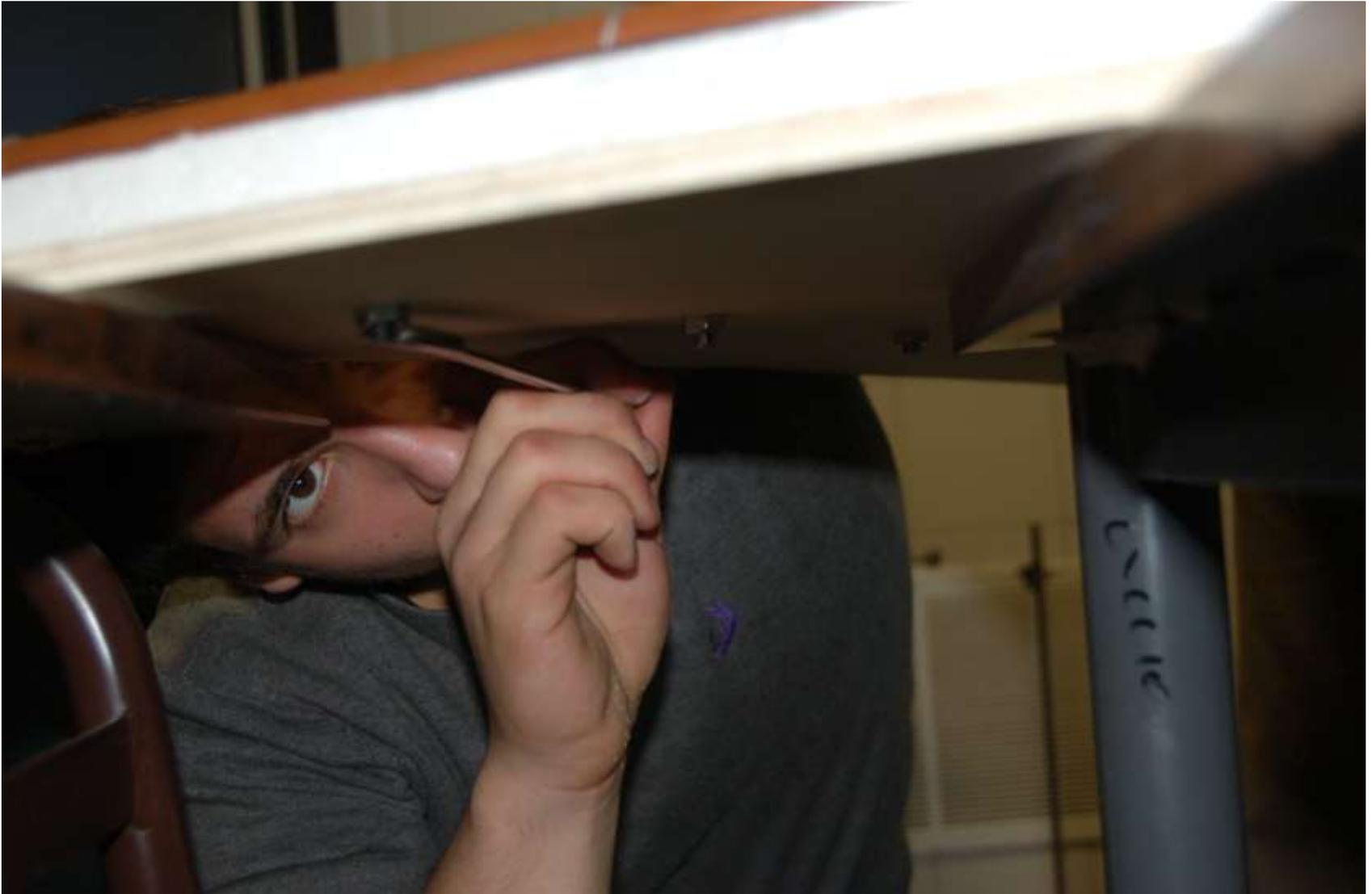
Serraggio dei bulloni che tengono unita la piastra assorbente al supporto di compensato.
