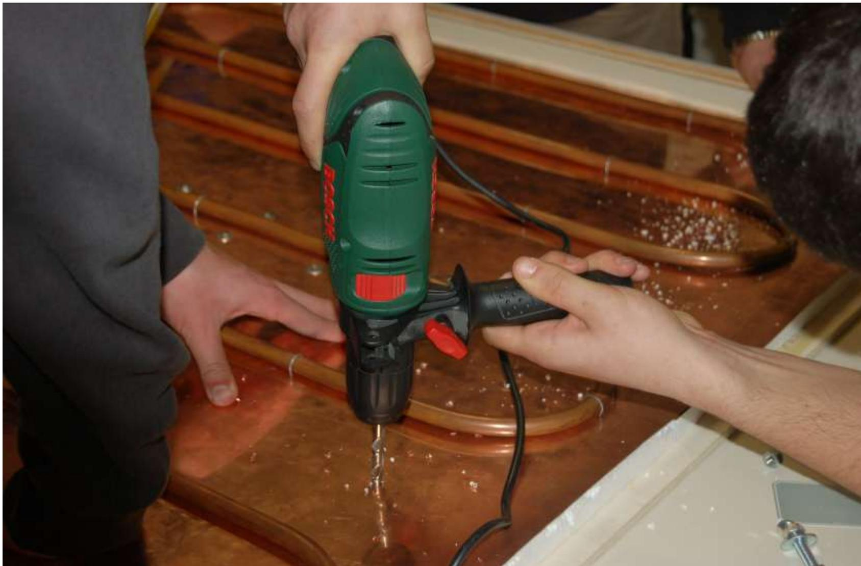
Foratura della piastra assorbente e del pannello di compensato per il passaggio dei bulloni che li tengono uniti, tra i due materiali abbiamo interposto una lastra di polistirolo di 2 cm di spessore con funzione di isolamento termico. Sono stati utilizzati 12 bulloni 8x50 mm con dadi e rondelle.
