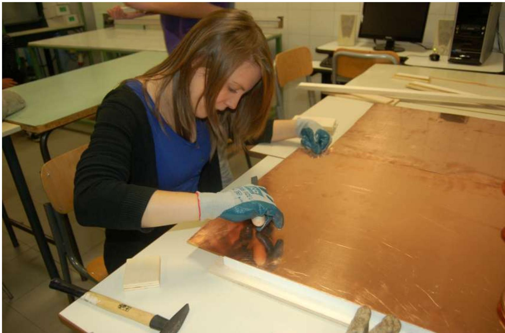
Limatura del bordo delle lastre in rame.
