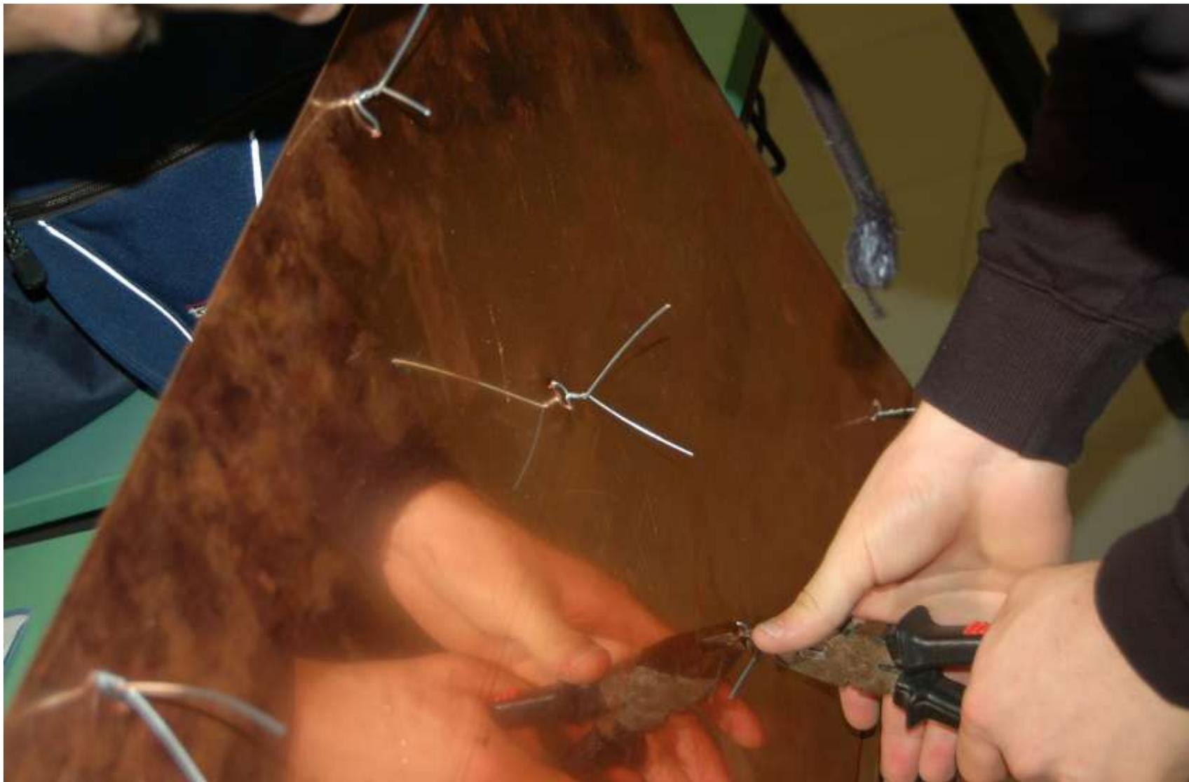
Sistemazione del filo di ferro che mantiene in contatto il tubo di rame alla piastra assorbente.
