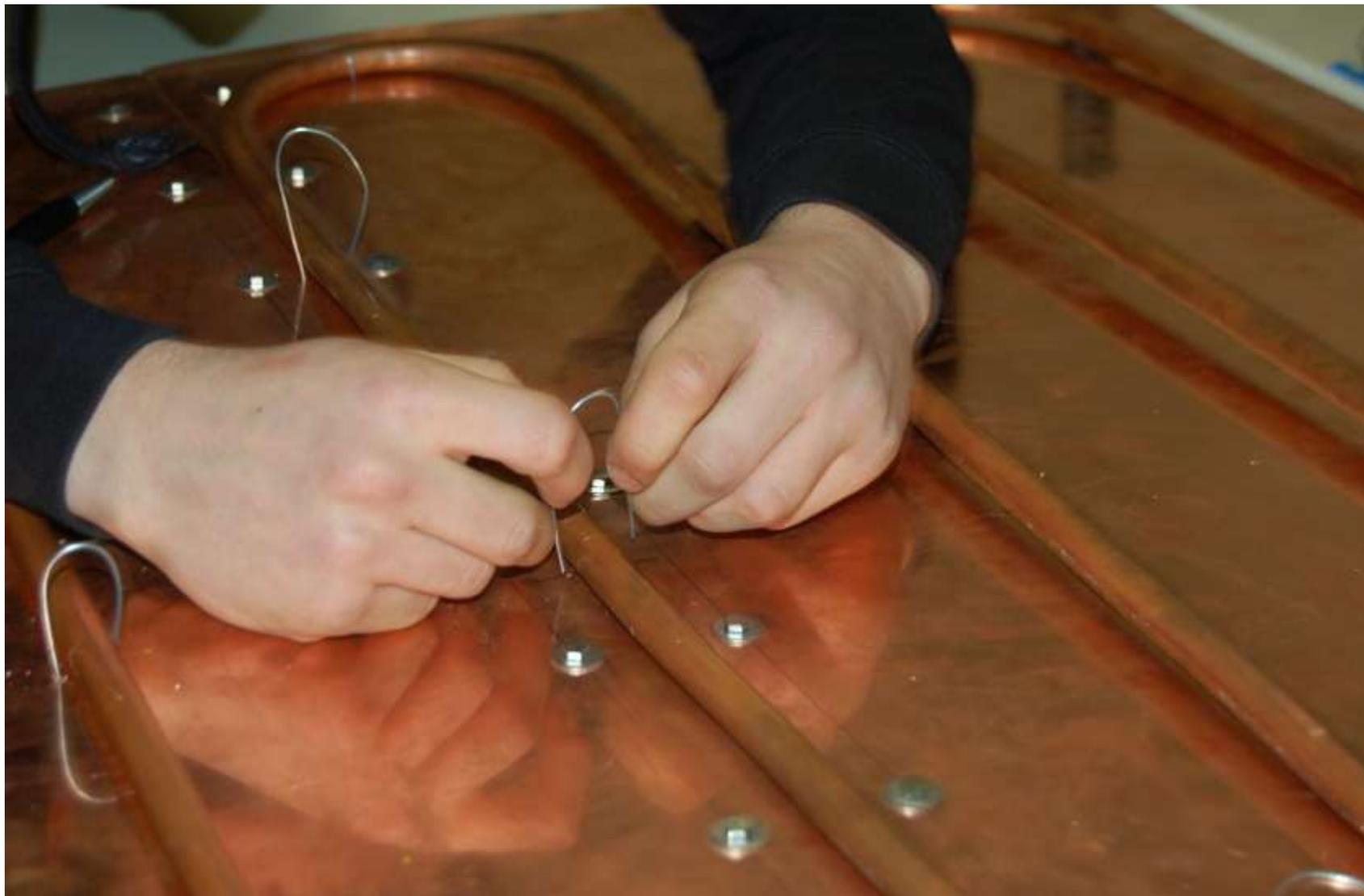
Sistemazione del filo di ferro che mantiene in contatto il tubo di rame alla piastra assorbente consentendo la trasmissione del calore.
