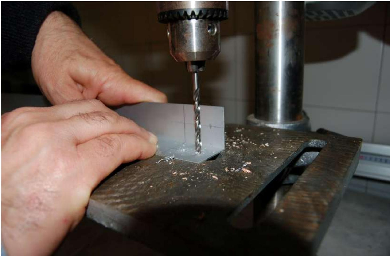
Costruzione degli angolari in alluminio per la realizzazione di alcuni giunti rigidi.
