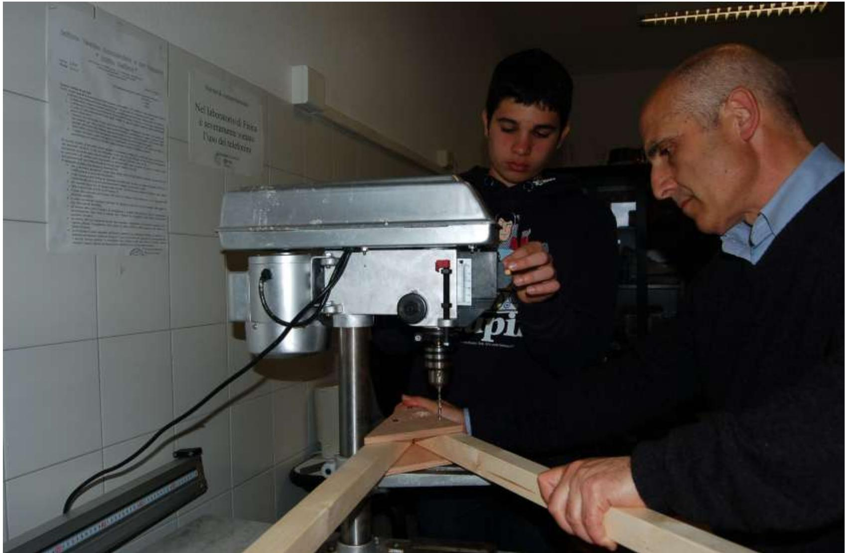
Foratura delle piastre di raccordo triangolari per il passaggio delle viti.
