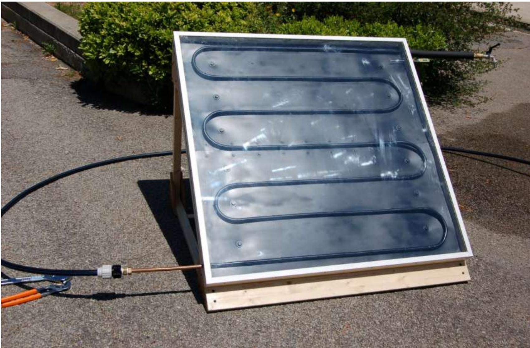
Prove di temperatura nel cortile della scuola, la tubazione è collegata all'impianto di irrigazione delle aiuole. Il pannello è esposto a Sud, l'angolo di tilt è di  $41^\circ$  (Latitudine di Olbia).
