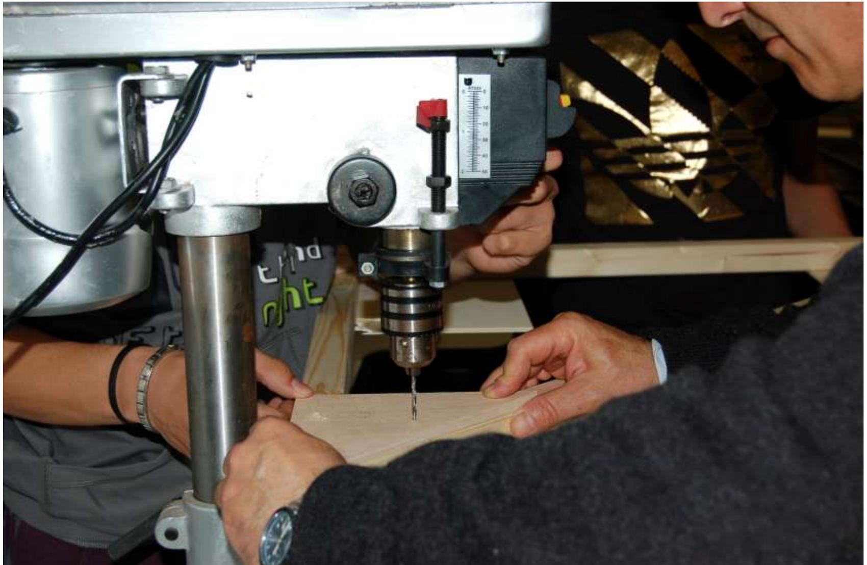
Foratura delle piastre di raccordo triangolari in compensato marino.
