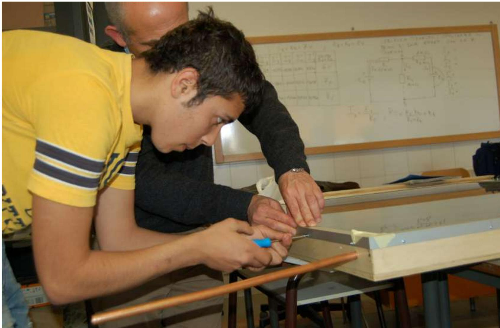
Sistemazione di un coprifilo in alluminio che copre le irregolarità e tiene unita la lastra di vetro al telaio in legno.
