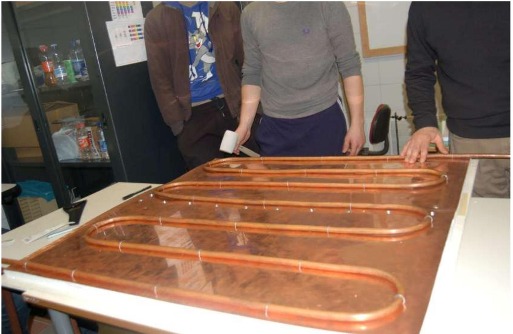
L'ancoraggio del tubo di rame alla piastra assorbente è stato ultimato.
