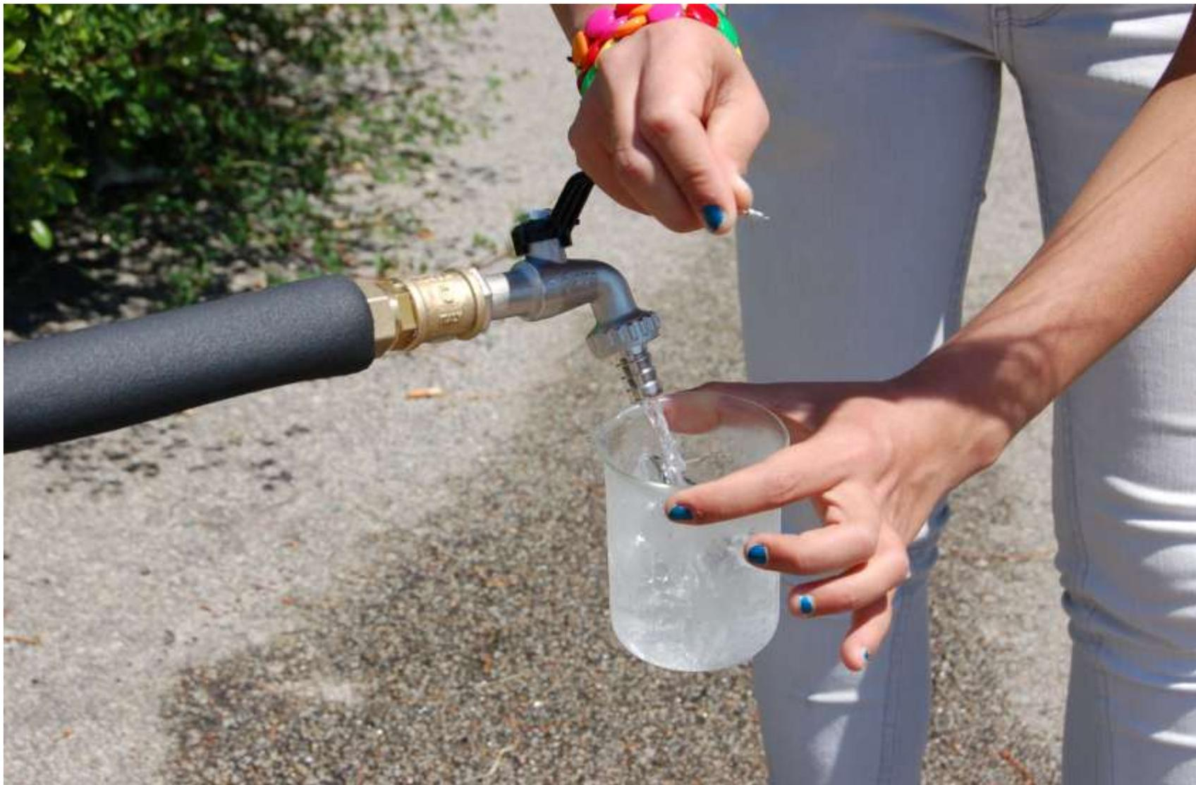
Prelievo acqua calda per misura della temperatura.
